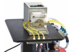
Schlauchpumpe zur Läppmittelversorgung
