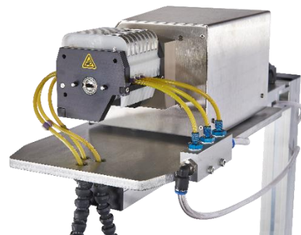
Schlauchpumpe zur Läpp- und Poliermittelversorgung
